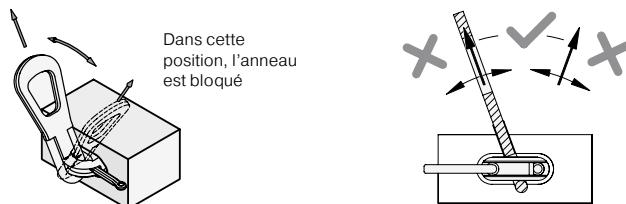
Si l'anneau est en traction vers le centre de la pièce au moment de l'application de la charge, l'étrier risque de se tordre.
